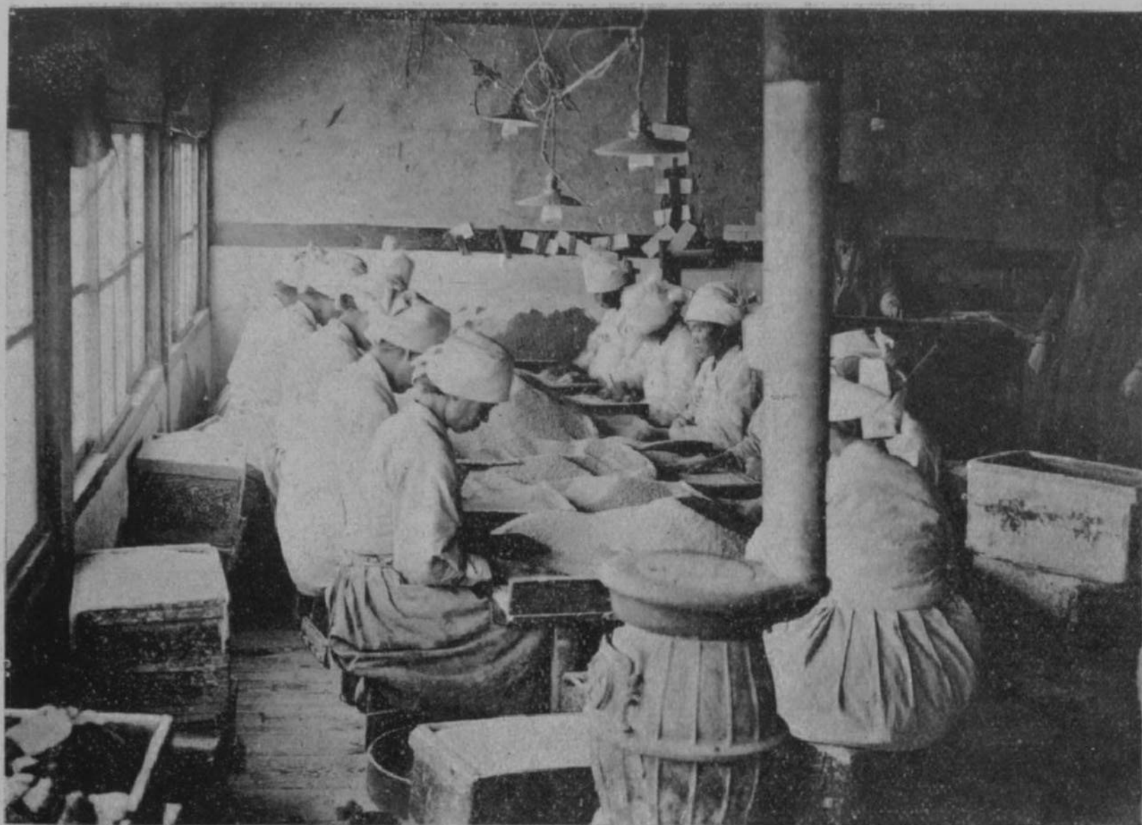
業作拔石場工米精安平（一のそ）場 工 米 精
