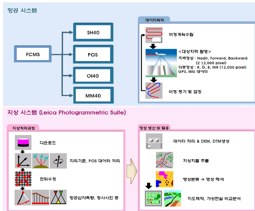
<그림 2-2> ADS40 시스템 및 데이터 작업 흐름도
