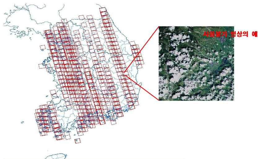
<그림 4-7> KOMPSAT2 촬영 궤적(예) 및 사용불가 영상(예)
