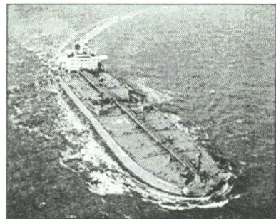
유조선은 수송경비의 절감을 위하여 급속히 대형화되어 왔는데, 1955년 이전에는 5만 DWT를 넘는 선박이 없었으나 1973년에는 48만DWT급의 초대형선까지 취항하게 되었다. 최근에는 20만DWT 이상 30만DWT 미만의 유조선을 VLCC(Very Large Crude Oil Carrier)라 부르고, 30만DWT 이상의 유조선을 ULCC(Ultra Large Crude Oil Carrier)라 부르고 있다.
